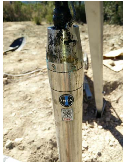
La sonda tiene un diseño alargado y de pequeño diámetro, para poder ser introducida con facilidad en las perforaciones.
