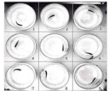
Imagen obtenida por el módulo de captura de imágenes para análisis del comportamiento de los peces
