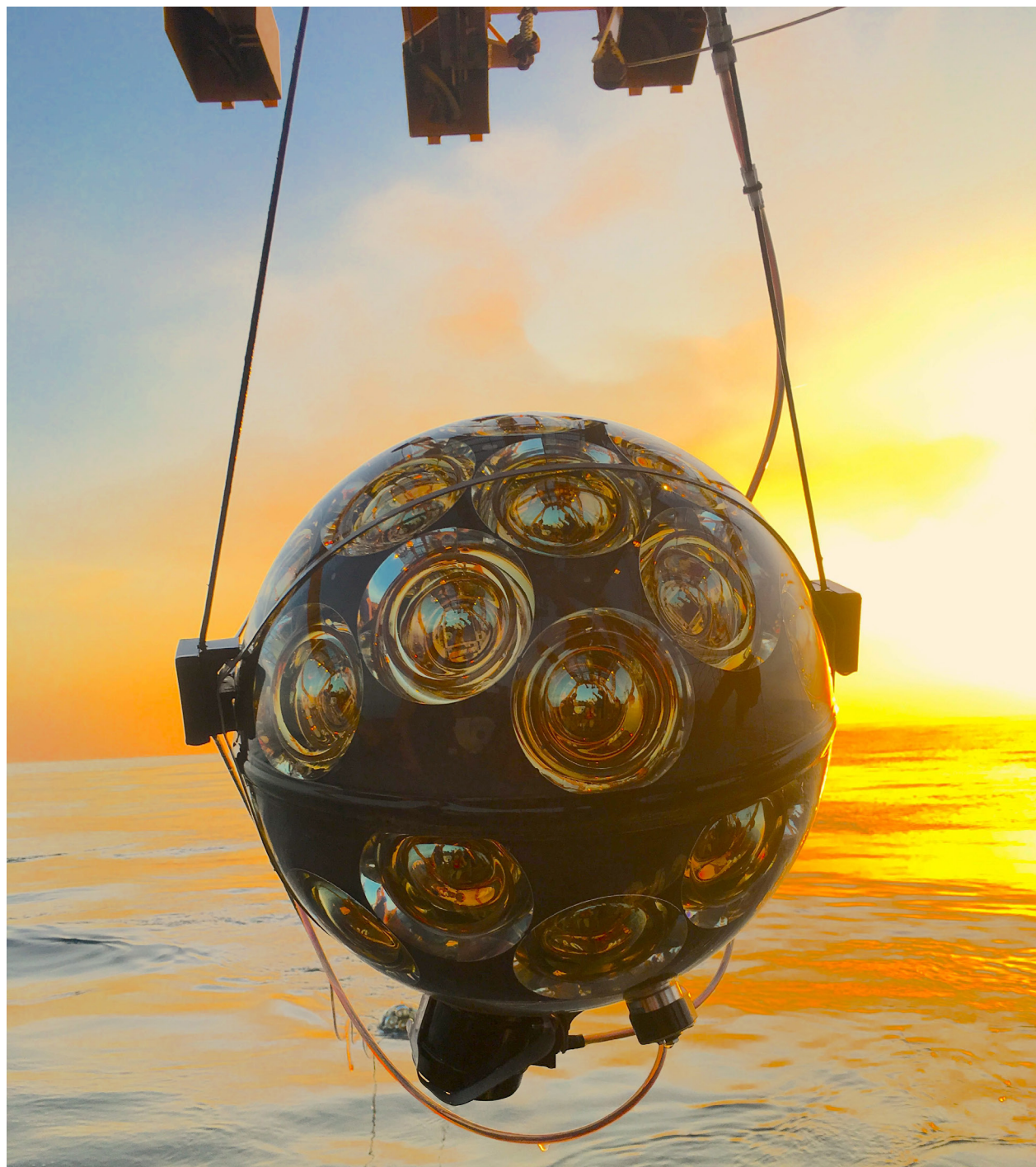
Uno de los miles de sensores del telescopio de neutrinos KM3NeT antes de su instalación en el fondo del mar Mediterráneo.
