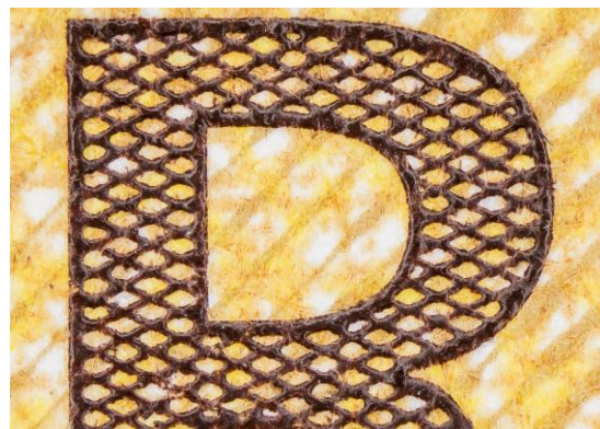
Trama de impresión de la tinta de la letra R de "EURO" en un billete de 50€ (con óptica 5X) realizada con el equipo.
