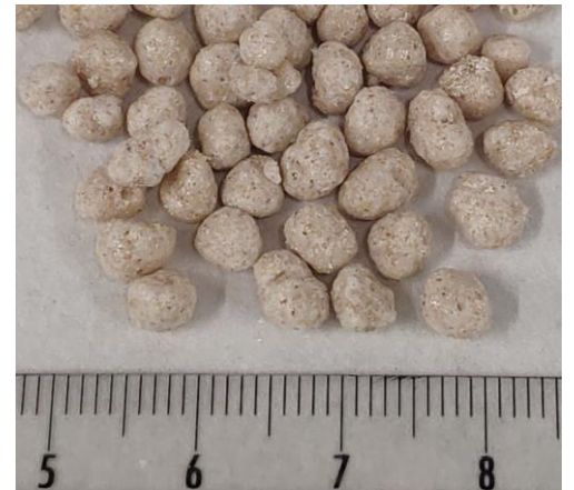
Los áridos ligeros presentan valores de densidad y resistencia similares a los de los áridos ligeros comerciales
