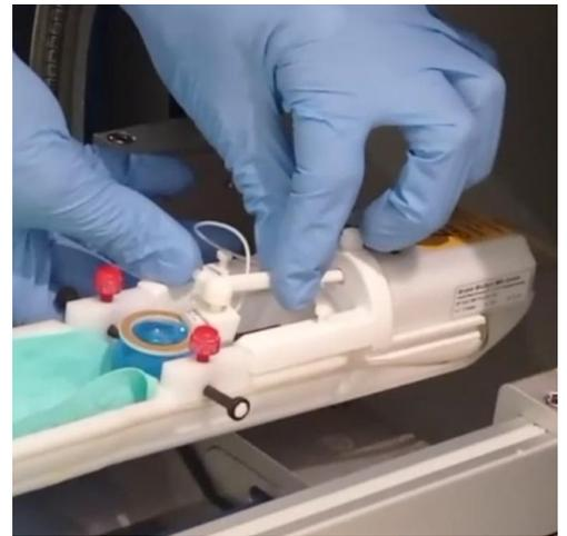
Dispositivo montado en un escáner de RMN para ser usado sobre un fantoma en una prueba de laboratorio.
