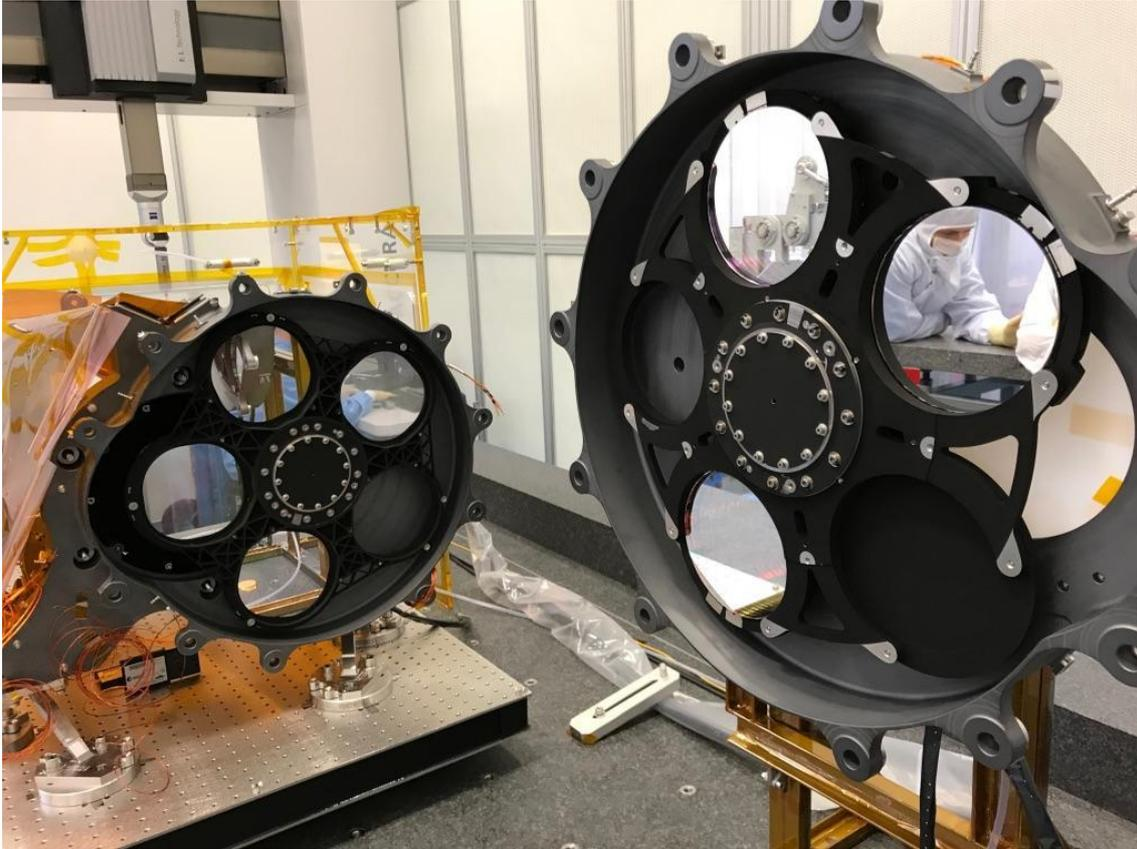
Rueda de filtros del instrumento NISP durante el proceso de tests en el laboratorio. Créditos: ICE-CSIC/IEEC/IFAE.
