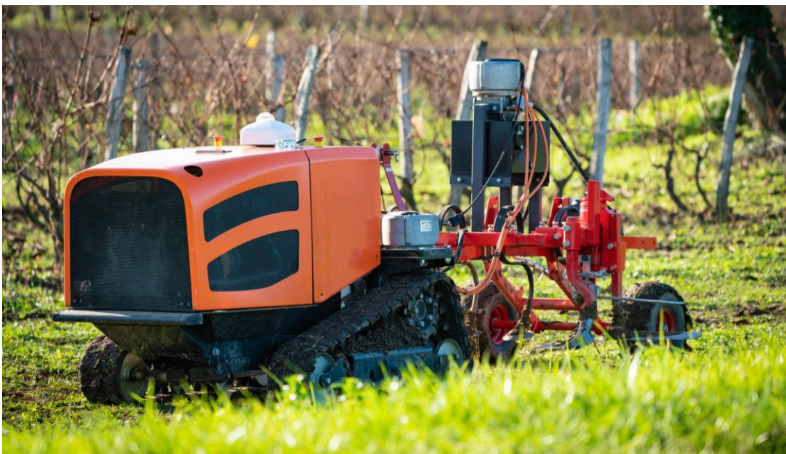
Vehículo con sistemas de discriminación de malas hierbas en cultivos. / Welaser
