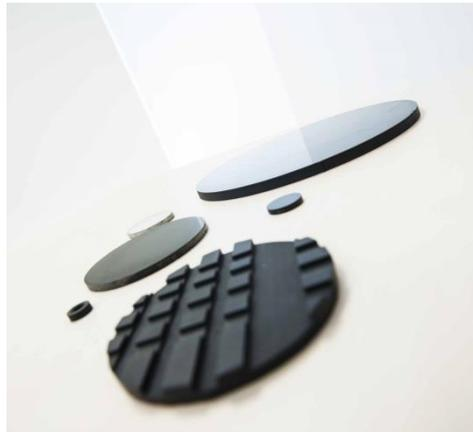
Preparación del material para obtener nanocompuestos cerámicos (izquierda) y el material final (derecha). / Lucas Melcón / CSIC Comunicación
