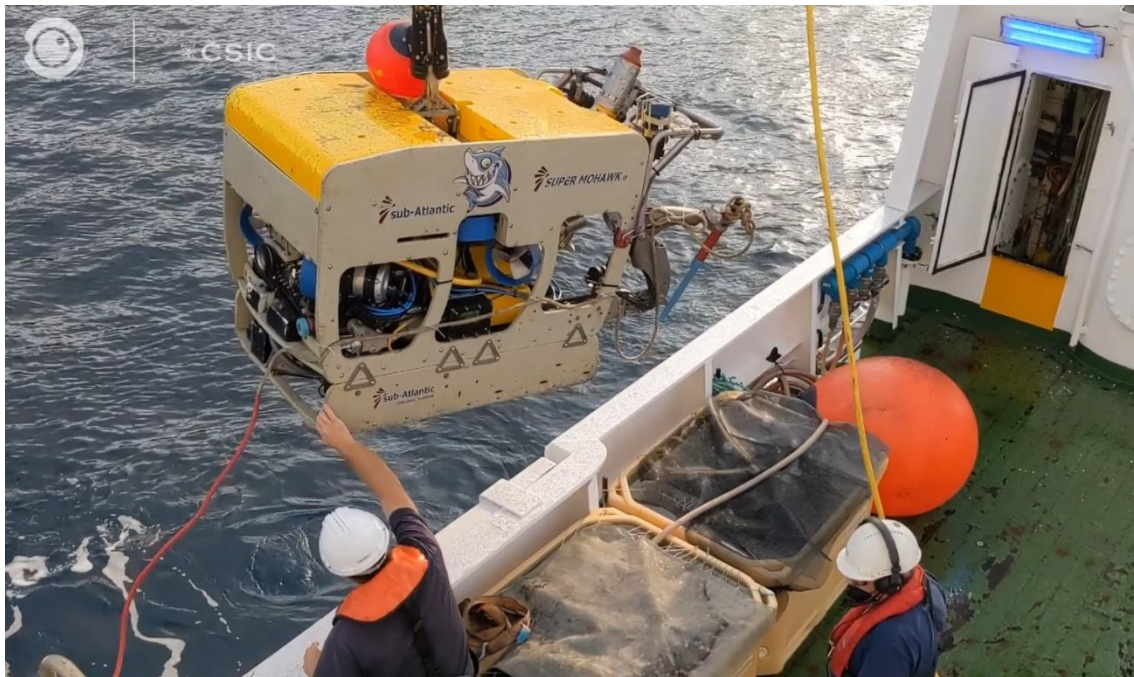
El vehículo submarino ROV Liropus, del Ángeles Alvariño, que asiste al buque cisterna en La Palma. / IEO-CSIC
