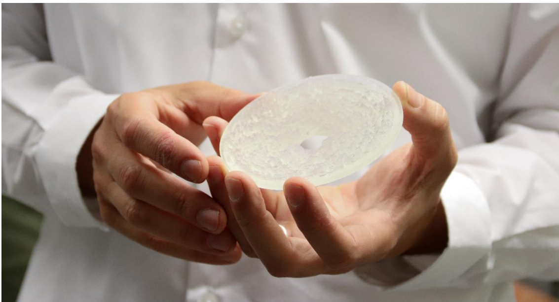
Muestra de un holograma acústico impreso en 3D./UPV.
