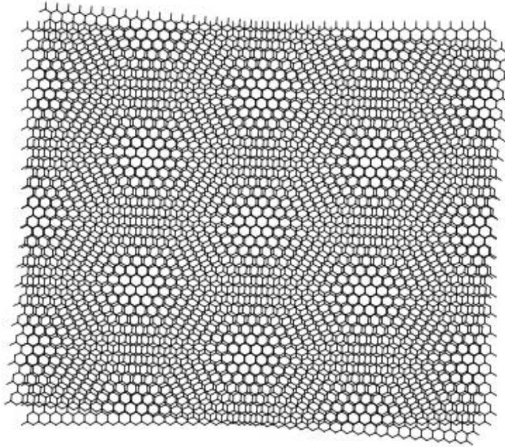
Al girar dos capas de grafeno se forma una super-red y al hacerlo con un ángulo de 1,1 grados actúa como los materiales superconductores no convencionales. / CSIC
