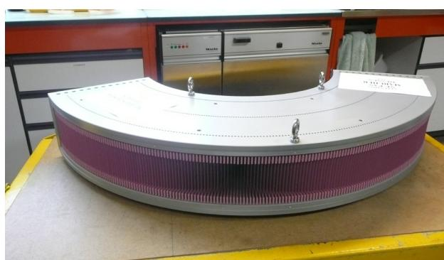
Imagen de las láminas absorbentes del ROC.
