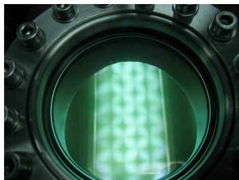
Figura 10. Plasma de iones de cobre, en un prototipo de magnetrón de área grande y erosión uniforme
