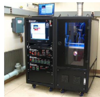
Equipo para crecimiento de grafeno mediante CVD y máscara para fabricar dispositivo
