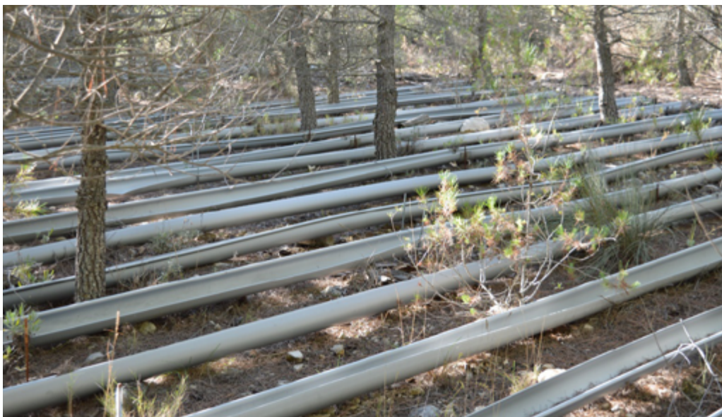
Sistema de exclusión de la precipitación aplicado por el CEBAS en un ecosistema semiárido dominado por Pinus halepensis
