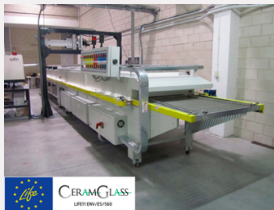
Horno con tecnología láser desarrollado por investigadores del ICMA.
