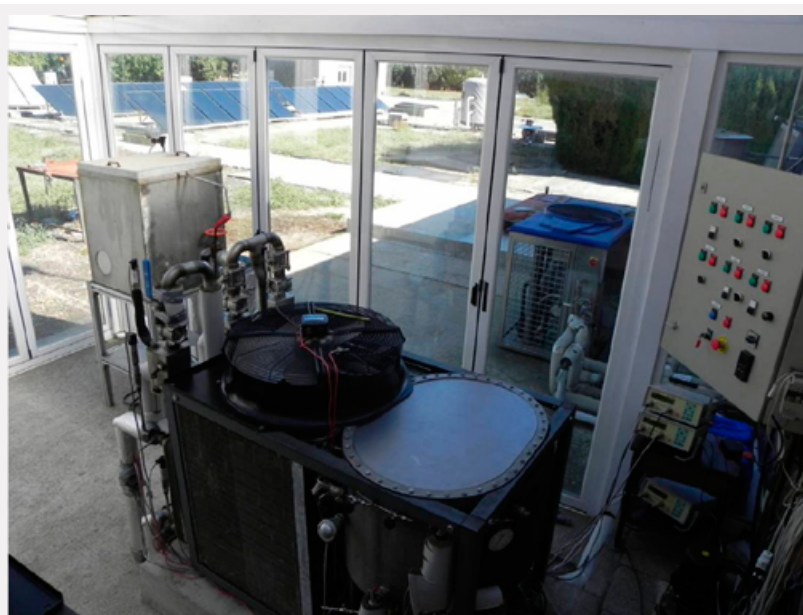
Prototipo de máquina frigorífica de absorción aire-aire y Split (M. Izquierdo, A. González-Gil, E. Palacios, Applied Energy , 130, 7–19, 2014)
