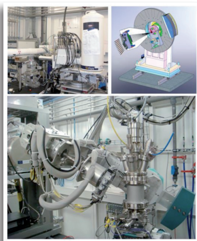
Detector de 13 elementos (Si/Li) instalado en la estación de Xas (Arriba a la izquierda). Nuevo detector HRPD con 10 detectores con cristal analizador (Arriba a la derecha) Cámara de UHV especialmente diseñada para la estación de SXR (Abajo).
