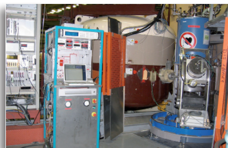
Equipo D15 en configuración de “normal beam” con un crió-ímán de 6T e insert de temperatura de 50mK.
