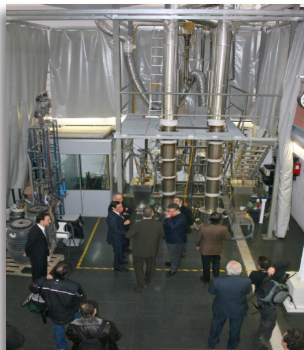
Figura Planta experimental de captura de CO 2 por carbonatación calcinación en el INCAR
