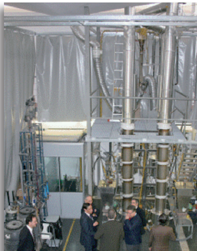
Planta experimental de captura de CO 2 por carbonatación calcinación en el INCAR
