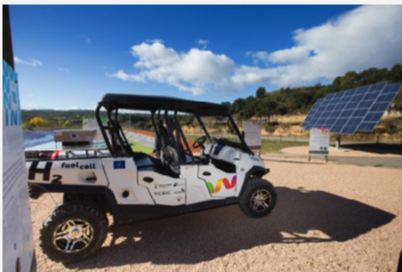
Vehículo todo terreno híbrido que funciona con una pila de combustible de hidrógeno desarrollada dentro del proyecto REWIND, en el que participa el LIFTEC.
