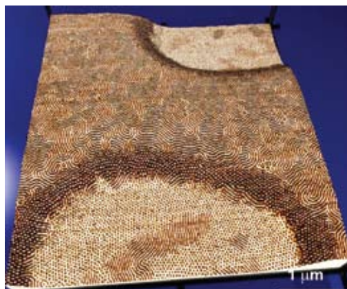
Imagen de AFM (phase imaging) de la superficie de un polímero. La estructura del polímero (cilindros paralelos o perpendiculares a la superficie) depende de su espesor.
