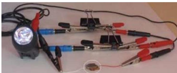
Micropilas alimentando una linterna Micro fuel cells powering a torch.
