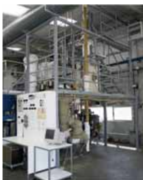
Planta piloto de combustión con captura de CO 2 (ICB) Pilot combustion plant with CO 2 capture (ICB)
