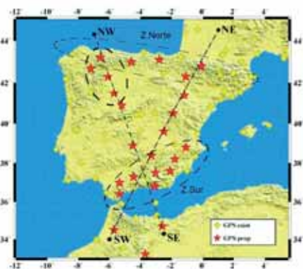
Proyecto Topolberia: Distribución proyectada de las nuevas estaciones GPS (estrellas rojas) durante la primera mitad del proyecto. Las estrellas amarillas indican las estaciones permanentes ya existentes y que se encuadran en el proyecto.
