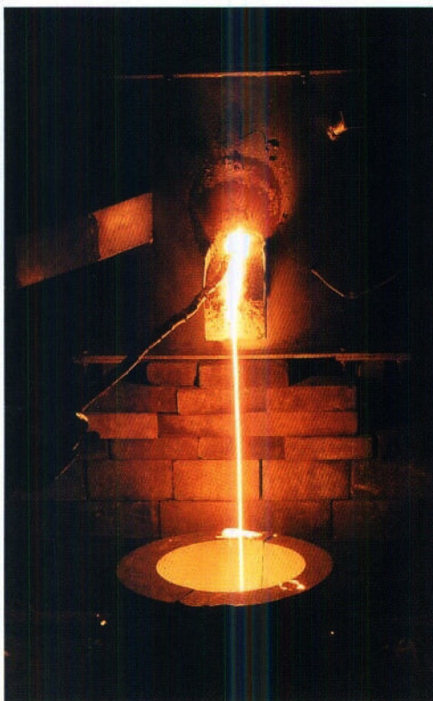
Colada de acero en un horno de plasma. CENIM.
