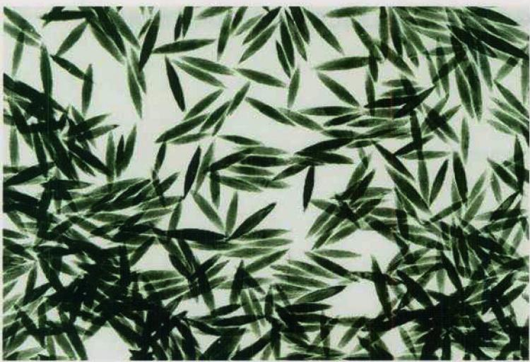
Partículas nanométricas (500 nm) de  $\gamma\text{-Fe}_2\text{O}_3$  preparadas por hidrólisis homogénea en solución.
