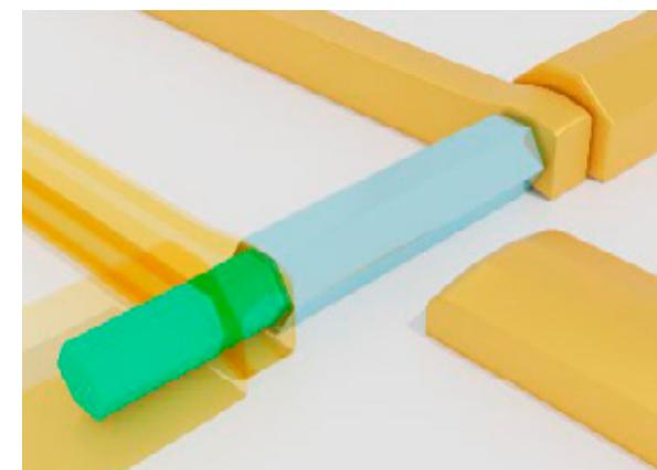
Esquema del dispositivo de nanohilos que es la base del protocolo experimental propuesto para combinar las espectroscopías túnel y Coulomb en un mismo dispositivo, reduciendo las ambigüedades presentes en la detección de partículas de Majorana. En color turquesa se puede ver el núcleo de InAs, recubierto por Al (color azul). En amarillo las conexiones de Ti/Au.
