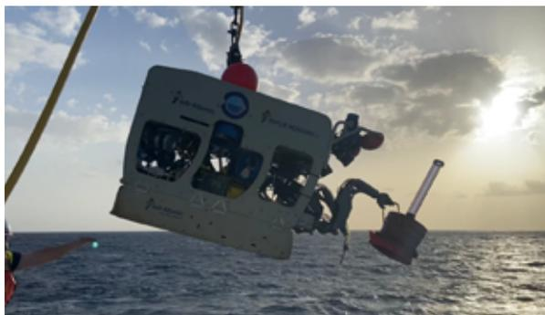
Instrumento para medir la velocidad vertical del flujo difuso de fuentes hidrotermales.
