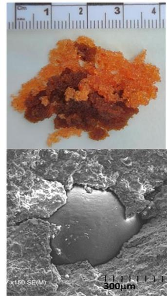
Resinas de intercambio iónico gastadas y resina inmovilizada en el cemento activado alcalinamente
