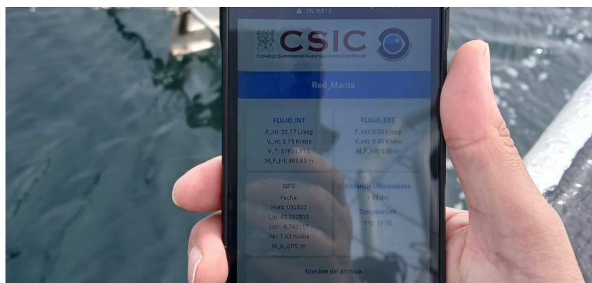
**Sistema modular que cuantifica en tiempo real el volumen de agua filtrada y la profundidad efectiva de muestreo, aportando precisión, trazabilidad y eficiencia a los programas de monitorización del medio acuático.**
