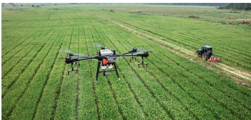
**Las sequías exigen tecnologías más precisas para medir la humedad del suelo. La solución usa un sensor en dron que alcanza 50 cm de profundidad, con resolución de 20 m y cobertura de 30 ha/h. Permite monitorizar grandes áreas y optimizar riego y detectar fugas de agua con alta eficiencia.**
