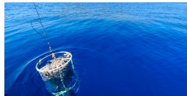
Muestreo de agua de mar con roseta oceanográfica (COMA_2024).
