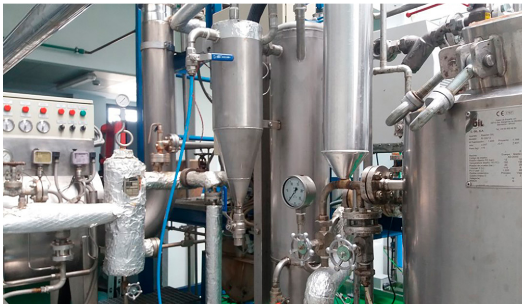
Reactor de tratamiento térmico de la planta piloto de fitoquímicos y columnas cromatográficas de laboratorio, desarrolladas para la extracción y purificación del comselogósido a partir de subproductos del aceite de oliva.
