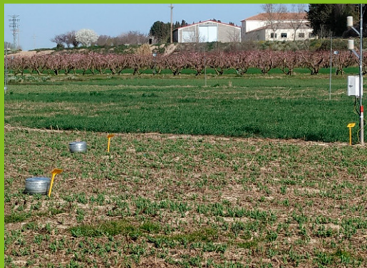
Medición de flujos de gases de efecto invernadero en parcelas de cultivo. La monitorización ambiental de los sistemas agrarios es imprescindible para evaluar su efecto sobre el medio ambiente.
