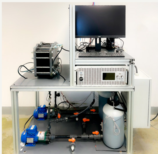
Banco de ensayos para baterías de flujo redox de hasta 1 kW de potencia.
