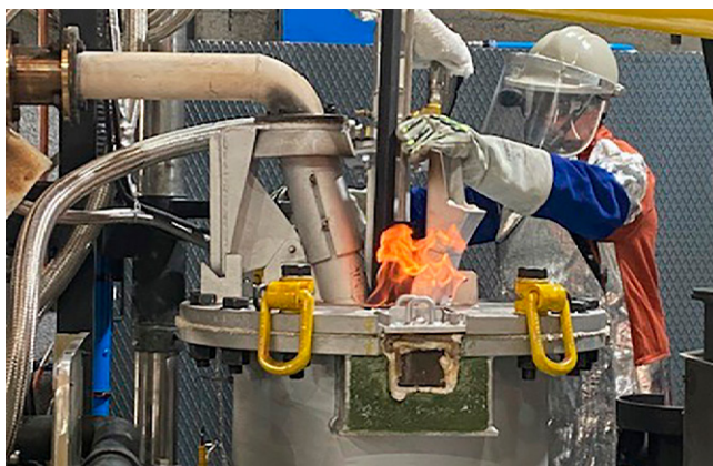
Planta piloto de lanza sumergida para la recuperación de metales críticos y estratégicos.
