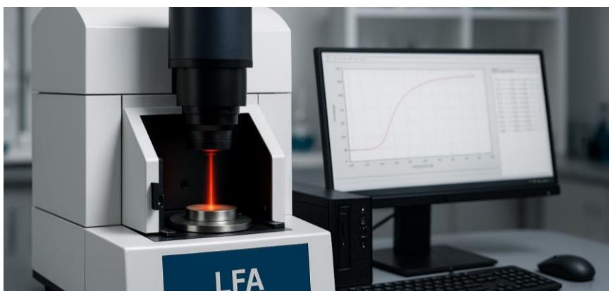
**Procedimiento modificado y optimizado de medición de la conductividad térmica con el LFA (laser flash Analysis). Incluye un software que permite medir con precisión la conductividad térmica en capas muy delgadas de material (<0,1 mm).**
