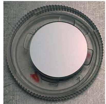
Superficie tipo de filtro para ultravioleta tras ser recubierto empleando la fuente térmica desarrollada.
