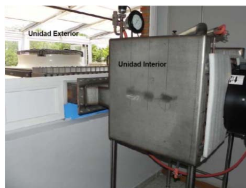
Prototipo de máquina frigorífica de absorción aire-aire y split instalado en el banco de ensayos.
