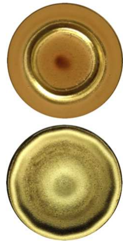
Superficie del blanco tras: 5% de uso en un magnetrón estándar (arriba) y más de un 20% de uso en un magnetrón FFE (abajo)
